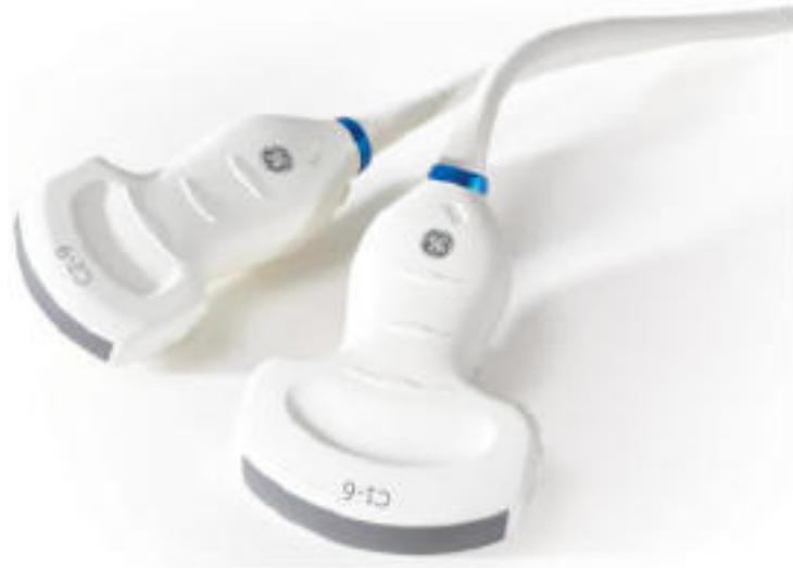
一本一本丹念に手作りされるプローブは、100 $\mu$ m ( $\mu$ mは1000分の1mm)厚の3枚の部材を気泡が入らないように絶妙な力加減で接着する技術や、6cmx1cmのプローブ内の基板上で、幅0.2mmの128本の信号線を正確かつスピーディに半田付けする技術など、高度な微細加工スキルが必要とされる。これに加えて、新たな素材であるシングルクリスタルの加工には、ミクロン単位でのカッティングや数多くの細かな加工条件の最適化が不可欠だが、日野工場ではこれまで蓄積してきた「匠」の技術をもとにこのほど、GEヘルスケアのプローブ拠点で初めて、シングルクリスタルプローブの製品化に成功した。
