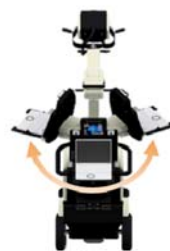
(a) ベッドサイドでの運用イメージ (b) コンソール側アーム旋回角度 \pm 110^{\circ}
