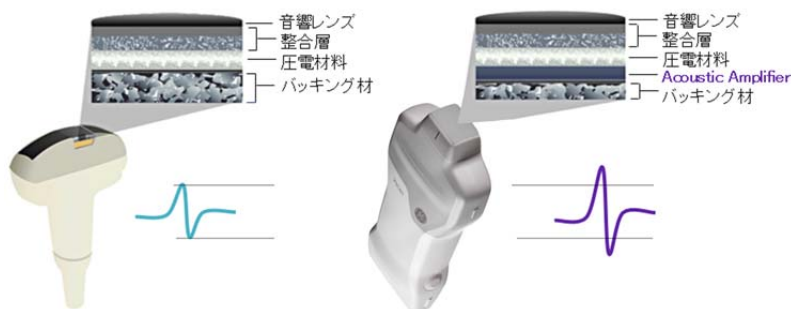
図3 従来の探触子(左)と Acoustic Amplifier 導入の探触子(右)
