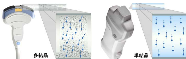
図2 多結晶構造(左)と単結晶(右)
