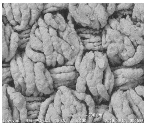
図2 「ZIEG」のフレキシブルシールドの電子顕微鏡写真(×100)
