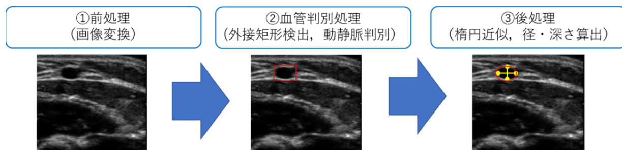
図3 血管判別アシスト機能のアルゴリズム概要
