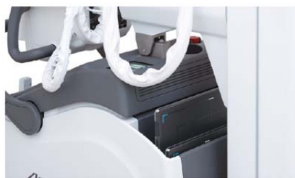
1417サイズあるいは 1717サイズ と、1012サイズの 2枚を装填可能 図4 フロントキャビネット外観
