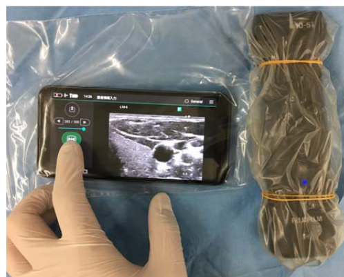
図2 プローブと表示機をカバーした例
