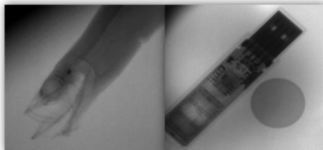
図2  $Al_2O_3$  を主成分とするファインセラミックプレートによるX線画像<sup>1)</sup>
