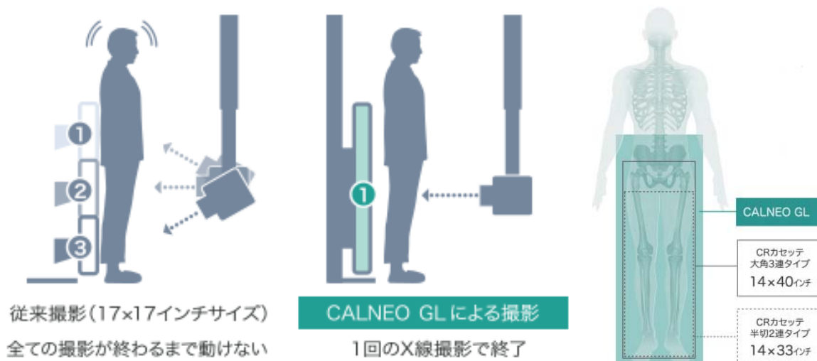
図1 既設の長尺撮影装置と『FUJIFILM DR CALNEO GL』との比較
