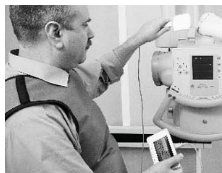
図 5 サーベイ検出器測定例
