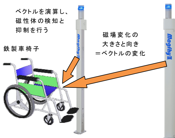
図3 ベクトル検知方式
