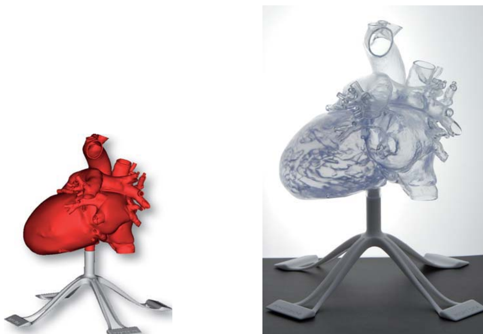
a) Mimicsで作成したCTからの3Dモデル b) a)3Dモデル(STL)を3Dプリンタで造形
