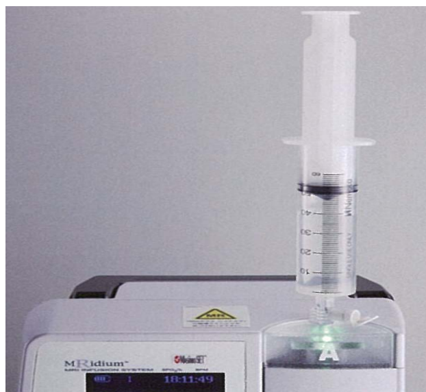
図 2 MRidium3860+に市販のディスポシリンジを装着した状態
