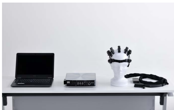
図 2 SPEEDNIRS 装置基本構成
