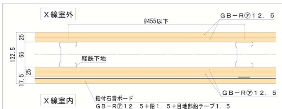
図 2 鉛付石膏ボード上貼り
