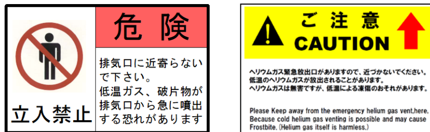
図 14：注意喚起標識の事例
