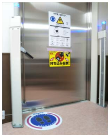
図 2 6) ポール型磁性体検知器
