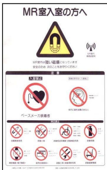
図 2 3) MRI安全標識例
