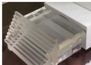
図7 X 線骨密度測定装置用精度管理ファントム
