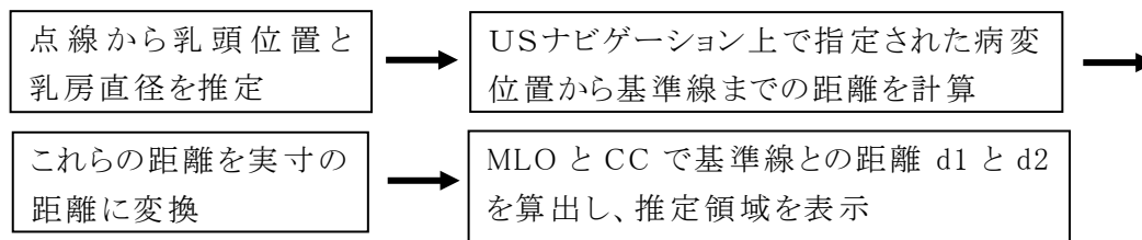
図8 USナビゲーションから病変位置推定処理の流れ
