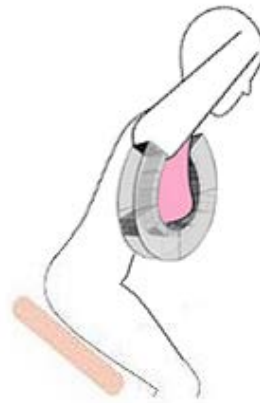
図8 4層 DOI 検出器(左)を搭載したマンモ用高分解能PETの模式図
