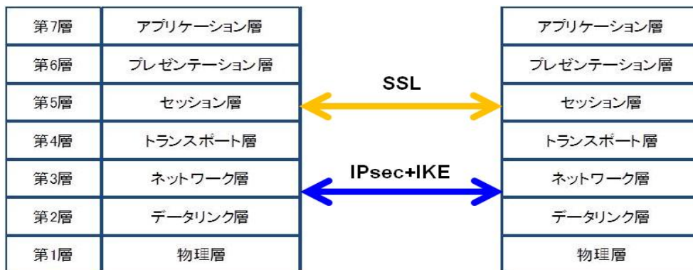
図4 OSI 階層モデルでの暗号化・認証手続き
