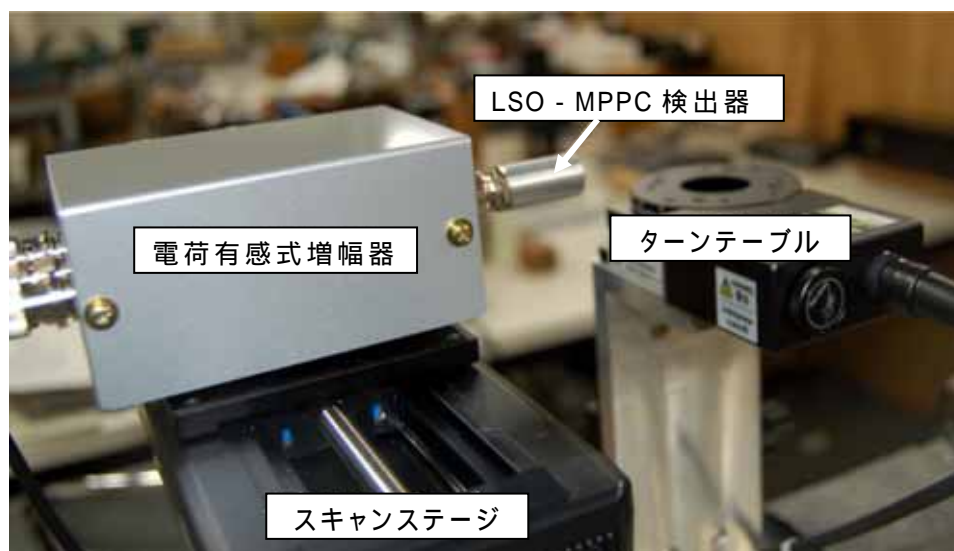
図2 LSO-MPPC 検出器、電荷有感式増幅器
