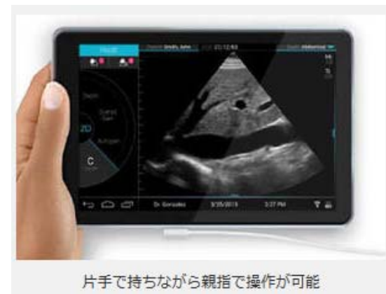
「SonoSite iViz」は、画面サイズ7インチの本体とセクタプローブで構成
