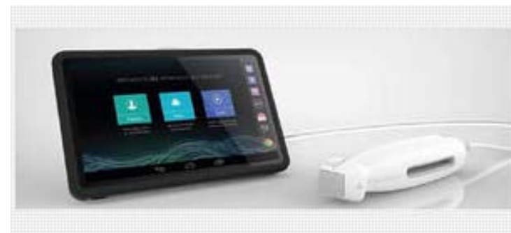
「SonoSite iViz」は、画面サイズ7インチの本体とセクタプローブで構成
