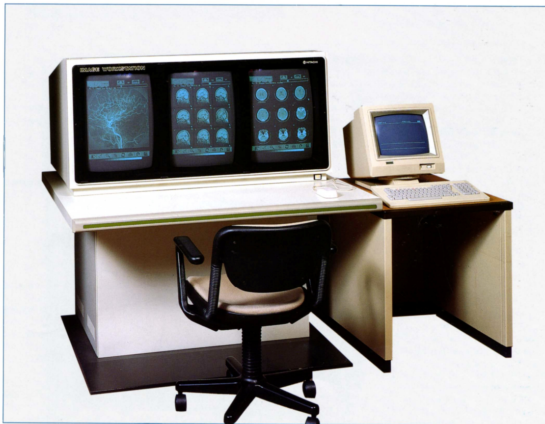
図4. 画像ワークステーションの外観 左側に表示部、右側にシステム開発のために用いたコンソール端末が示されている。この他に、CPUやオフラインデータ交換用の磁気テープ装置などが1台のラックに納められている。
