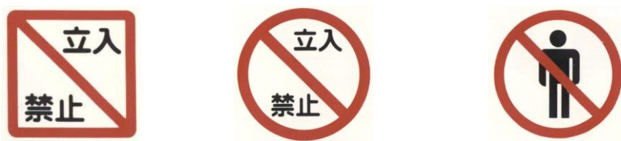
図3 立入禁止の標識例
