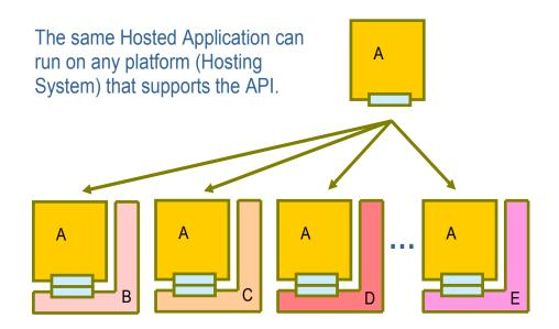
図1-2 ホスト型アプリケーションアーキテクチャによるプラットフォーム独立の概略図
