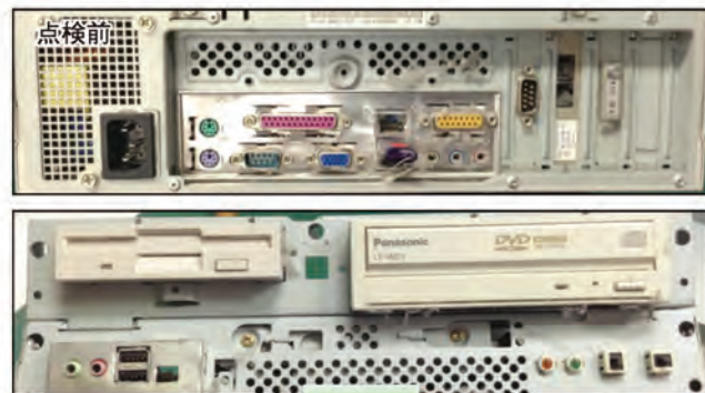
本体とカバーの間にホコリがたまり動作不良の要因となります。
